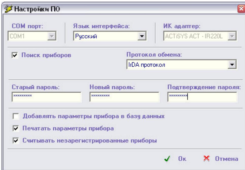
**COM порт** — позволяет выбрать коммуникационный порт компьютера, который будет использоваться для связи с прибором. Нельзя выбрать COM порт в случае, если выбран протокол передачи данных **IrDA протокол**.
